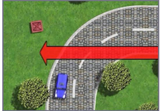
Das linke Bild zeigt ein Auto mit Dachgepäck, das auf eine Kurve zufährt. Fährt ein Auto durch eine Kurve, so tritt eine zum Kreismittelpunkt gerichtete
