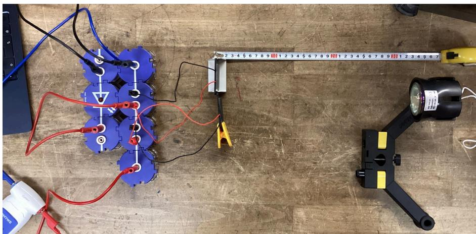
Versuchsaufbau der Reihenschaltung, mit PHYWE Experimentiermaterialien. Die Bypassdiode ist parallel zur ersten Solarzelle geschaltet.
