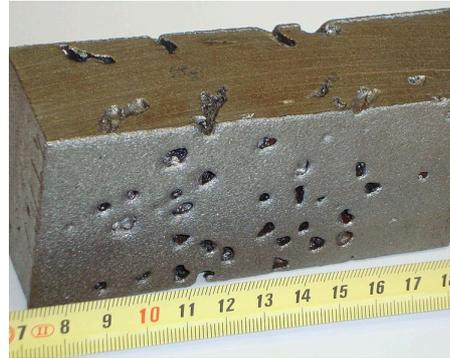
Gasporosität in GS-20Mn5 - Gussstahl at wikipedia - CC-BY-SA 3.0
