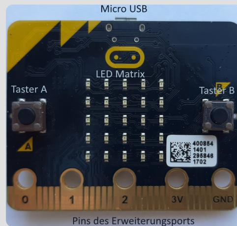
Der Microbit hat on-board mehrere Sensoren: **Lagesensor**, **Beschleunigungssensor**, **Magnetfeldkompass**, **Lightsensor** und **Temperatursensor**, welche gleich direkt verwendet werden können.
