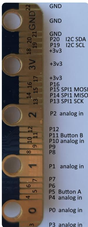
Am Erweiterungsport sind 21 frei programmierbare Pins herausgeführt. An die Pins P0, P1, P2, +3,3V und GND können Krokodklemmen angeschlossen werden. Um auch auf die anderen Pins zugreifen zu können ist ein **Breakoutboard** empfehlenswert.
