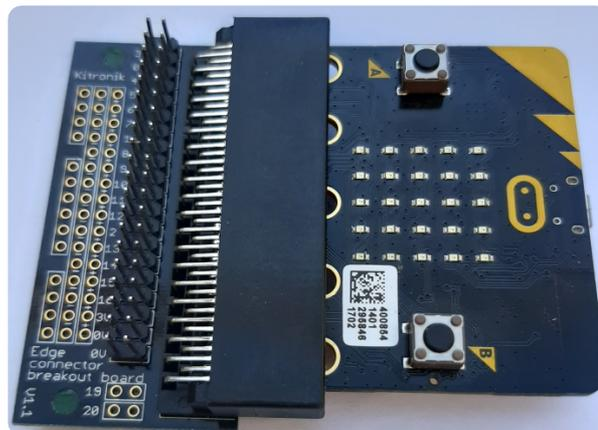
Einige Pins können sowohl digitale (0V oder +3,3V) als auch analoge Signale verarbeiten. (P0, P1, P2, P3, P4 und P10) Ob ein Pin die Signale digital oder analog verarbeiten soll muss zuvor in der Roboterkonfiguration angegeben werden.
