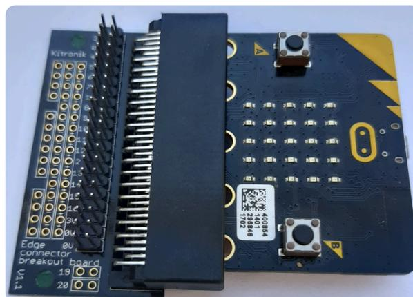
Einige Pins können sowohl digitale (0V oder +3,3V) als auch analoge Signale verarbeiten. (P0, P1, P2, P3, P4 und P10) Ob ein Pin die Signale digital oder analog verarbeiten soll muss zuvor in der Roboterkonfiguration angegeben werden. An Pin 19 (SCL) und Pin 20 (SDA) ist es möglich Sensoren, welche den I2C Bus verwenden, anzuschließen. Spezielle Breakoutboards beinhalten dafür einen Grove Anschluss.
