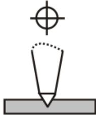
← Zum Ankörnen von **Lochmitten und Risslinien** verwendet man den Körner. Bohrlochmittelpunkte werden **zur Erleichterung des Anbohrens** kräftig angekörnt.
