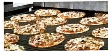
6 Schockgefrieren durch Stickstoff
