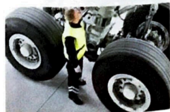
5 Mit Stickstoff befüllte Reifen
