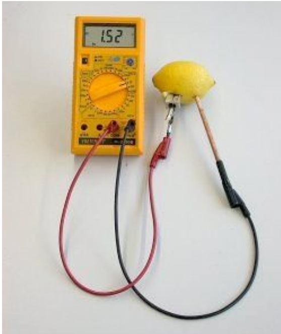
Abb.3: Zitronenbatterie (entnommen von: https://www.chemieunterricht.dedc2grundschversucheg-s-v-005.htm )
