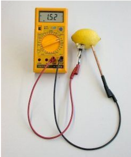
Abb.3: Zitronenbatterie (entnommen von: https://www.chemieunterricht.dedc2grundschversucheg-s-v-005.htm )
