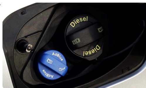
2015 Audi Q3 2.0 TDI quattro mit Tankzufüllstutzen für AdBlue
