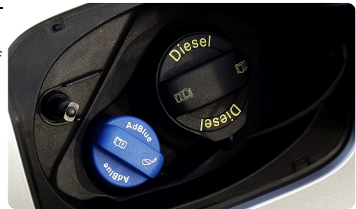
2015 Audi Q3 2.0 TDI quattro mit Tankeneinfüllstutzen für AdBlue
