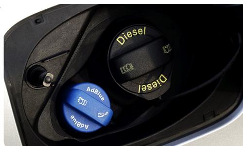
2015 Audi Q3 2.0 TDI quattro mit Tankeneinfüllstutzen für AdBlue
