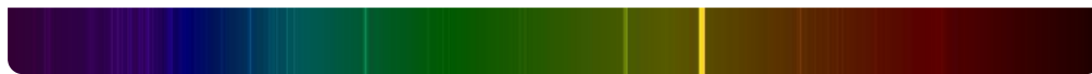
Das Spektrum von Natrium hat eine deutliche Bande bei gelbem Licht, was man sieht, wenn man Kochsalz in eine Flamme hält.
