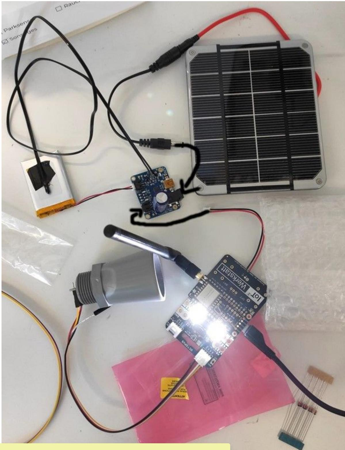
Hier wurde der Stromanschluss noch per miniUSB-Kabel (schwarzes Kabel unten rechts im Bild) gewährleistet. Im normalen Betrieb würden die Kabel (mit schwarzem Pfeil gekennzeichnet) eingesteckt werden.
