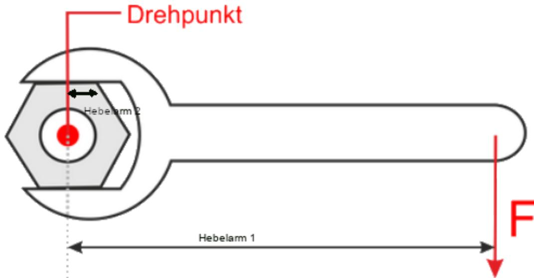
Beispiel eines Hebels: Schraubenschlüssel
