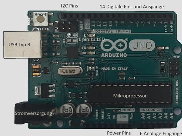
Der Arduino besitzt on-board keine Sensoren. Externe Sensoren können aber an die Pins des Arduinos angeschlossen werden.
