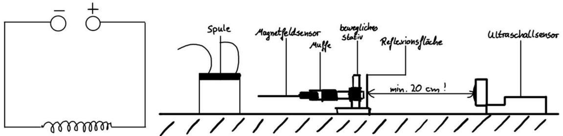
*Hinweis: Beachte, dass der Magnetfeldsensor genau mittig durch die Spule geführt wird. Andernfalls kann es zu Ungenauigkeiten in Nähe des gewickelten Drahts kommen.*
